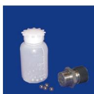
Meßkapsel mit 100 Stahlkugeln
